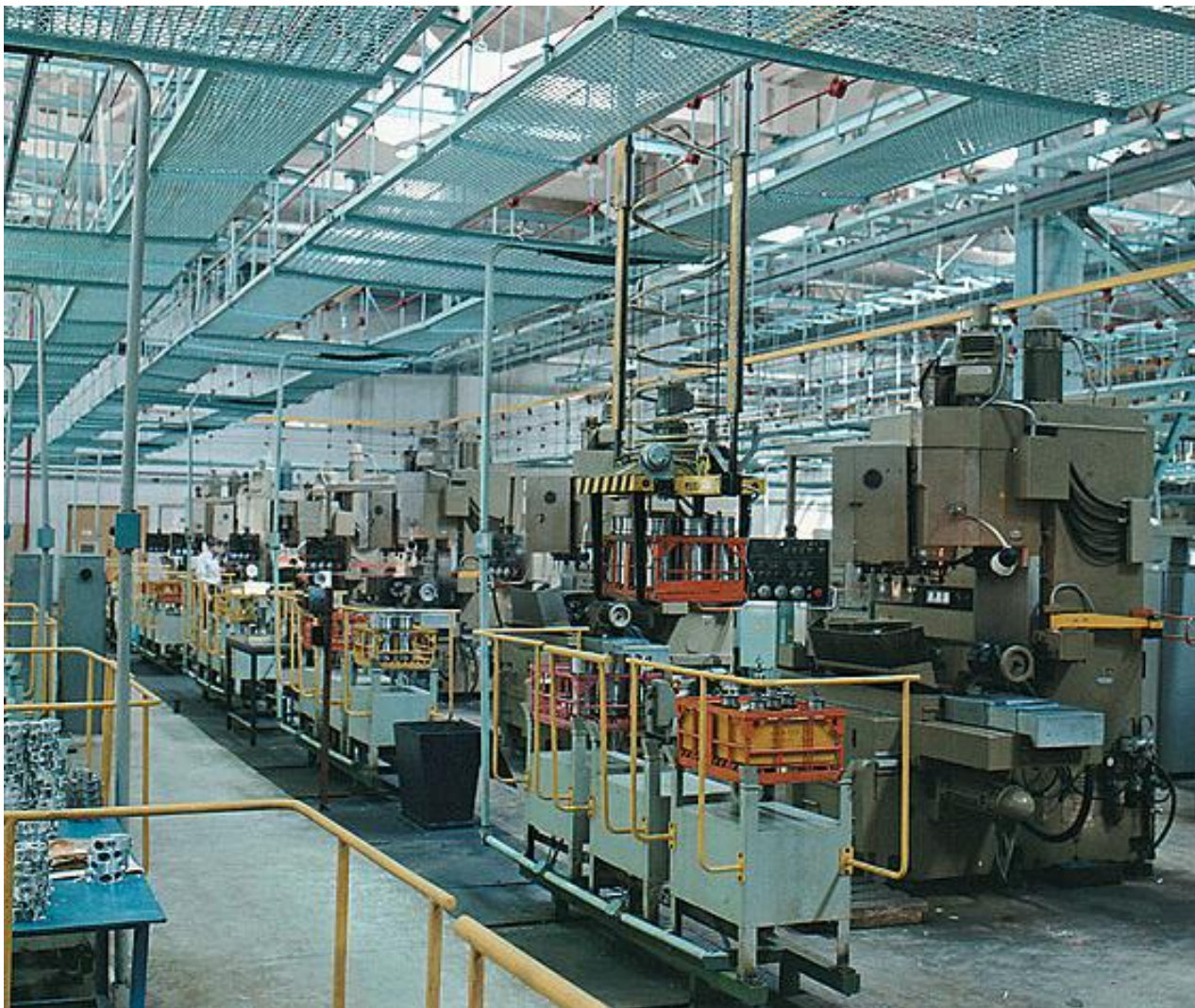
Рис. 19. ГПС механической обработки корпусных цилиндрических деталей
